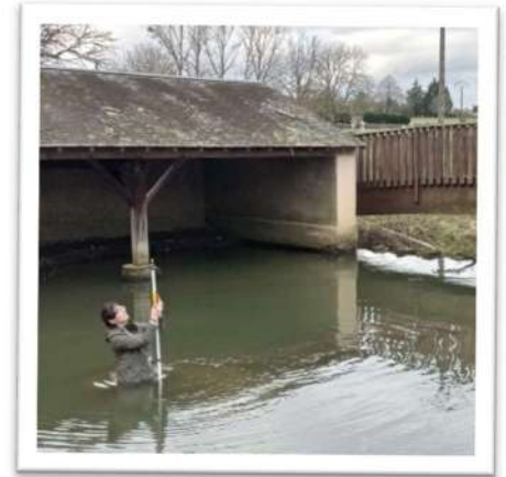
Perrine BOIREAULT-VADNAL mesure les hauteurs de fond et d'eau sur le Creuzançais à BOUESSE le 24 février 2023
