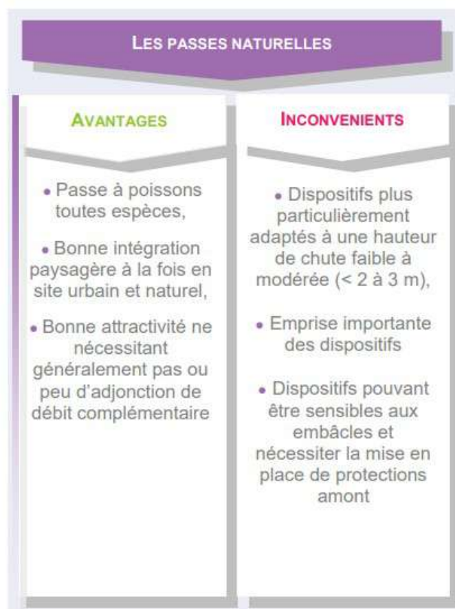
Illustration 47: Avantages et inconvénients des passes à poissons (source : VNF)
